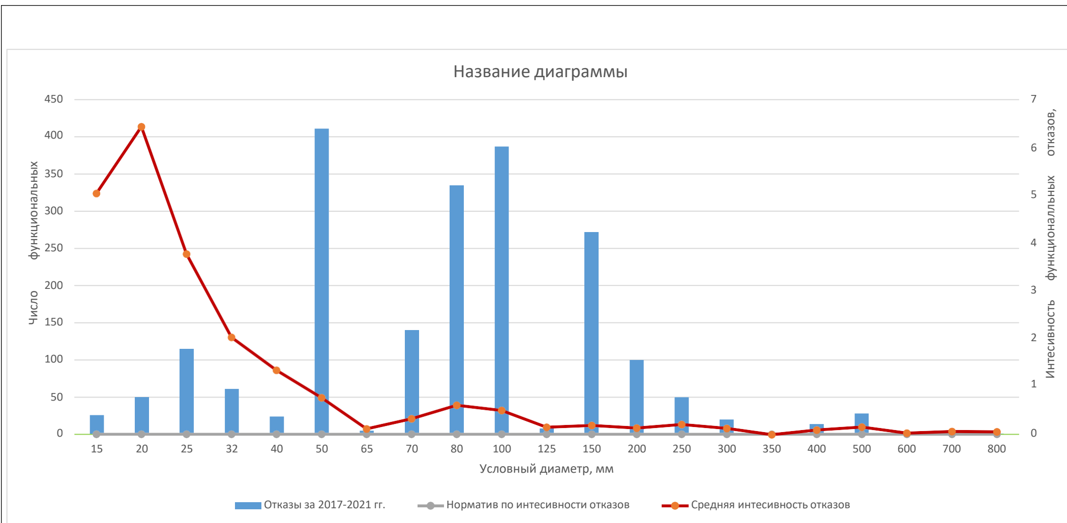
Рисунок 9.2 - Статистика и интенсивность функциональных отказов в зависимости от диаметра трубопроводов участков тепловой сети
